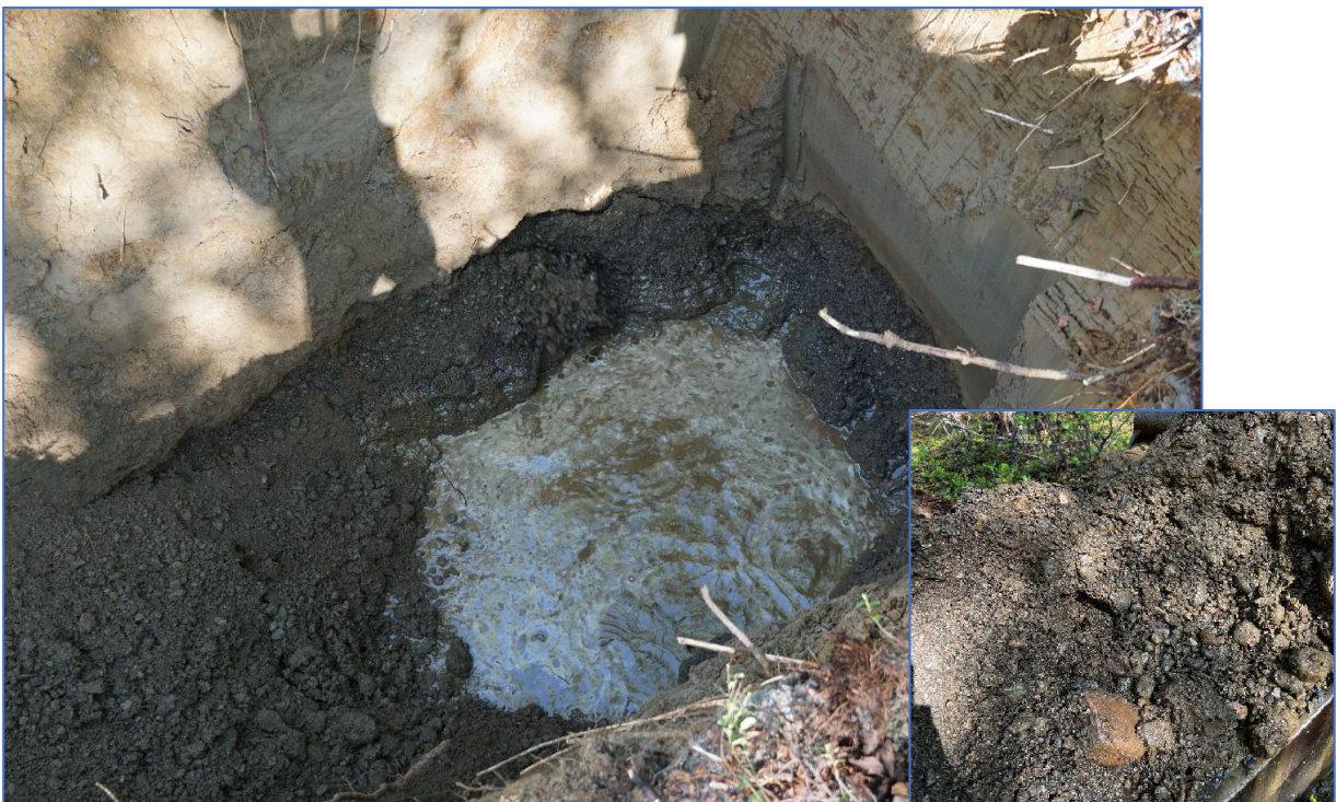
Figur 12: PG.6, utgravd til grunnvannstand og utgravde masser fra bunn (Bilde tatt av Norconsult 2022-06-03)
